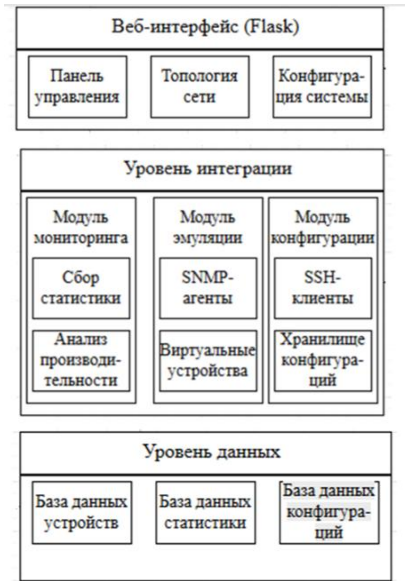
Рис. 2. Диаграмма компонентов системы мониторинга
