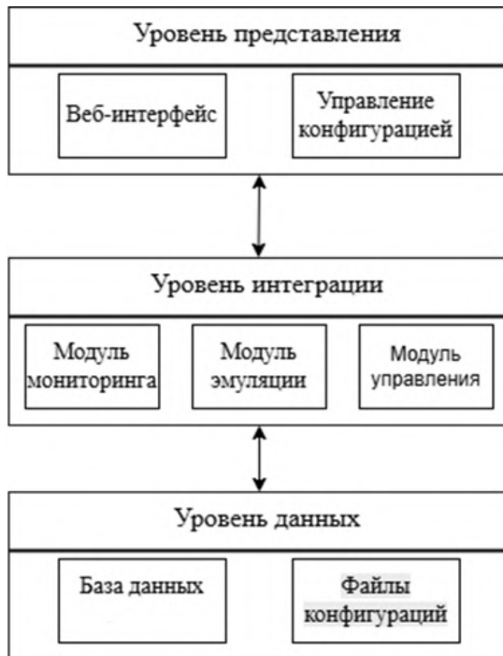
Рис. 1. Уровни системы мониторинга компьютерной сети
