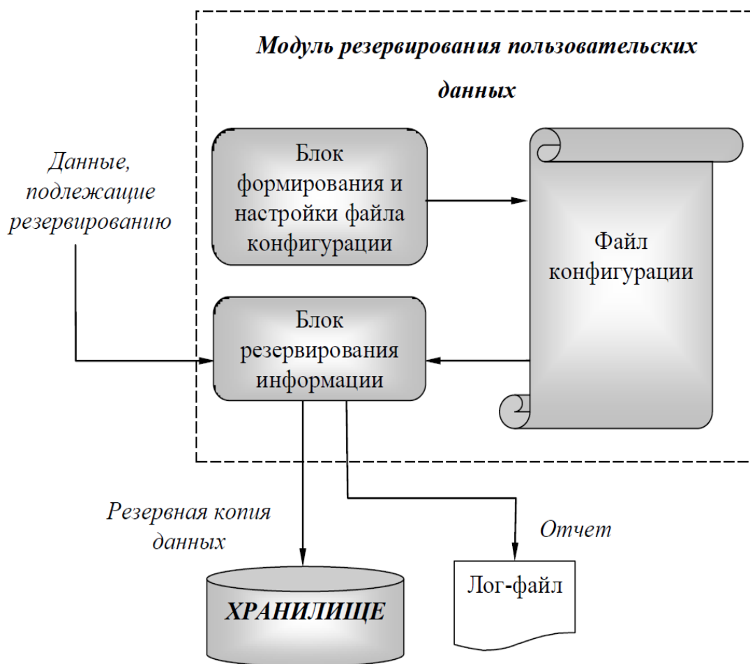
Рис. 3. Основные составляющие в системе, с применением которых реализуется резервное копирование
