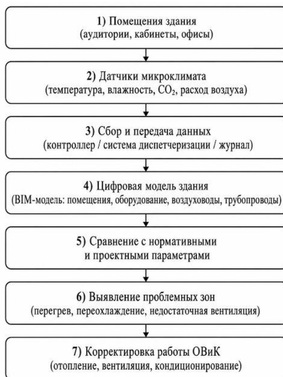
Рис. 1. Общая схема связи мониторинга микроклимата с цифровой моделью здания
