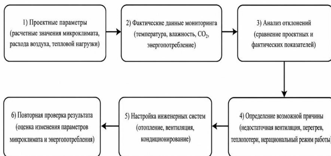
Рис. 2. Последовательность оценки эффективности инженерных систем по данным цифровой модели
