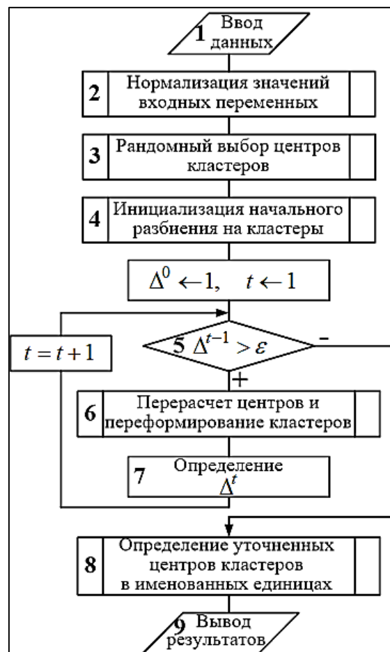
Рис. 2. Блок-схема метода четкой кластеризации (k-средних)
