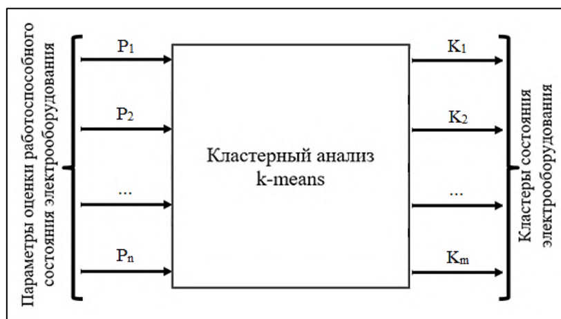
Рис. 1. Обобщенная структурная модель получения оценки работоспособного состояния электрооборудования
