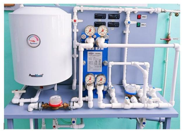
Рис. 2. Лабораторный стенд пластинчатого теплообменного аппарата
