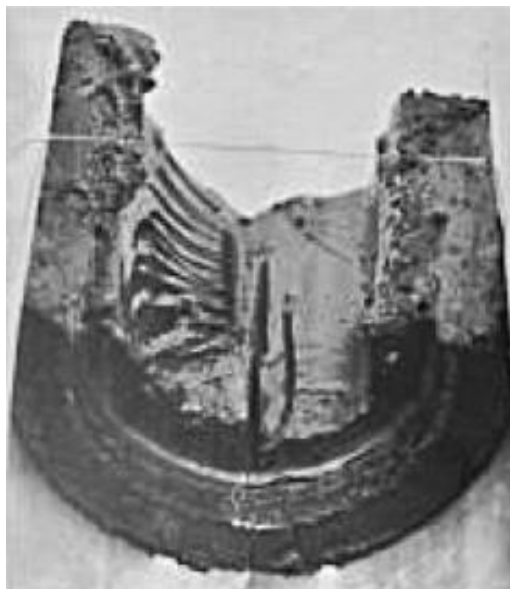
Рис. 2. Внешний вид отложений, изъятых из ротора центрифуги КамАЗ, отработавшего на стандартном минеральном масле около 8000 км
