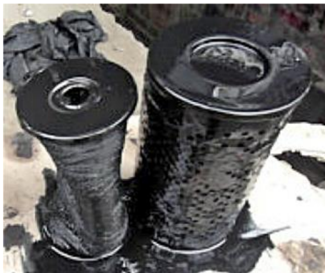
Рис. 4. Состояние фильтров грубой и тонкой очистки масла при работе дизелей класса Евро-3 на смеси моторных масел
