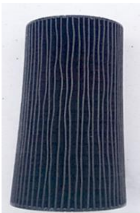
Рис. 5. Внешний вид ФТОМ дизеля, отработавшего на стандартном масле SAE 5W-40 15000 км
