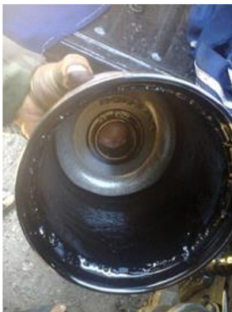
Рис. 3. Вид внутреннего пространства ротора центрифуги Скания, отработавшего на синтетическом масле около 15000 км
