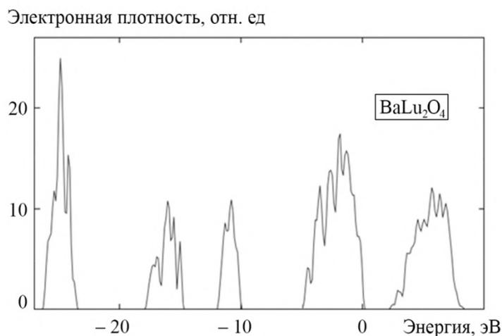
**Рис. 15. Электронная плотность в квантовом слое соединения  $BaR_2O_4$**
