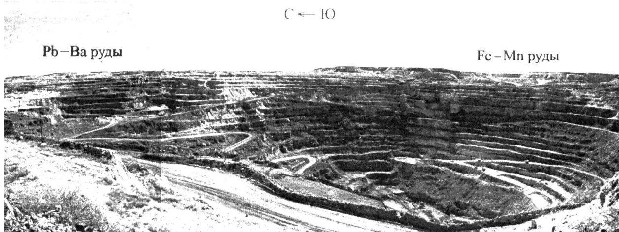
Рис. 9. Карьер месторождения Ушкатын–Ш. Справа в карьере добываются окисленные марганцевые руды, а слева вскрыты пока верхние горизонты окисленных сульфидно-баритовых руд [8, с. 229].
